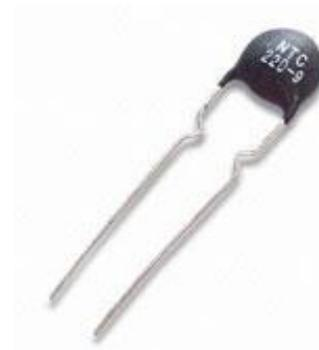
Fig: NTC Thermistor
